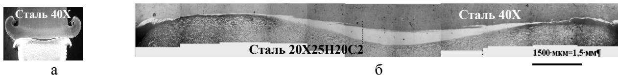
Рис. 3. Соединение при КСТ: а – макрошлиф; б – панорама сечения соединения
